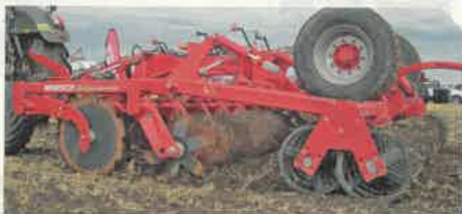
A HORSCH Joker 5 HD nehéztárcsa közvetlenül az aratás után bevethető, 12–13 mm mélységig képes bedolgozni a szármaradványt. A Joker HD nehéztárcsa az 5 évvel ezelőtti sikeresen bevezetett Joker RT nagytestvéreként jelent meg. A Joker HD-t még 6 és 8 m munkaszélességgel gyártja a Horsch, a 6 méteres húzásához 220–300 lóerő, a 8 méteres verzióhoz 270–380 lóerő szükséges.
