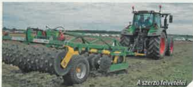
A kétrétegű talajművelést szolgálja a FraMest – DuoTill kultivátor, amely segítségével elérjük, hogy a felső 6–10 cm-es réteg és az alsóbb 10–35 cm-es réteg a helyén maradván legyen megmunkálva. A FRAMEST DUOTILL 3000 hét darab késsel, 28 cm mélyen 12 cm rövidtárcsa-mélységgel, lezárt, vethető talajállapotot hoz létre. Ezt a technikát a strip-till talajművelés hívei is szívesen alkalmazzák. (czm)
