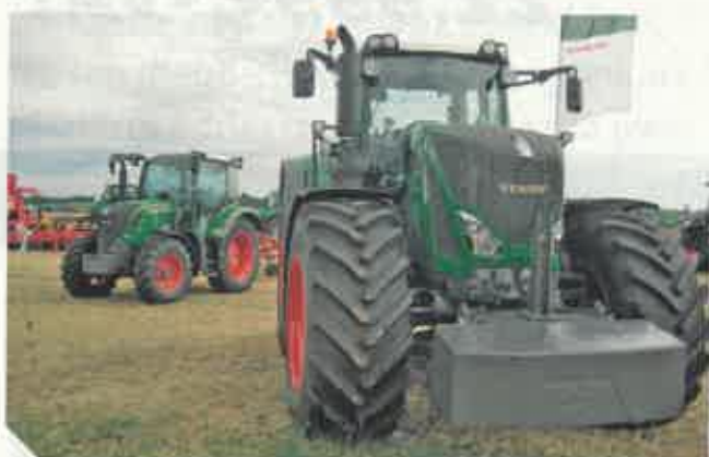
A FENDT traktorok közül a 130 lóerős Fendt 313 Vario (háttérben) volt jelen, amely megfelelő a zöldterületek, szántók és különleges kultúrák műveléséhez, háztáji traktorként való felhasználáshoz.
