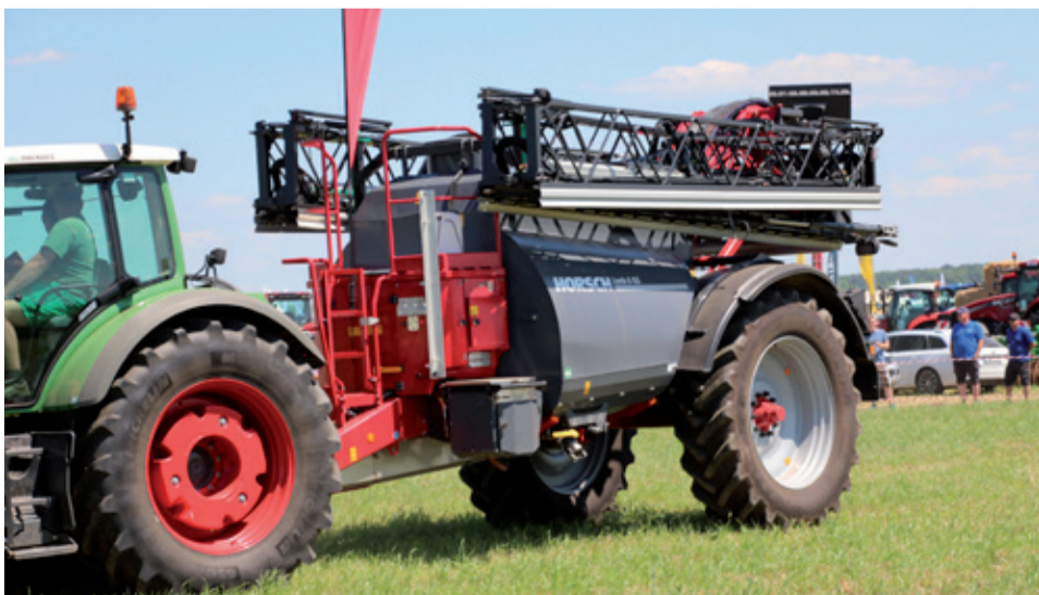
Ťahané postrekovače modelovej triedy GS sa vyrábajú s objemom nádrže 6 000, 7 000 a 8 000 l, pričom nádrž je vyrobená z nehrdzavejúcej ocele.
