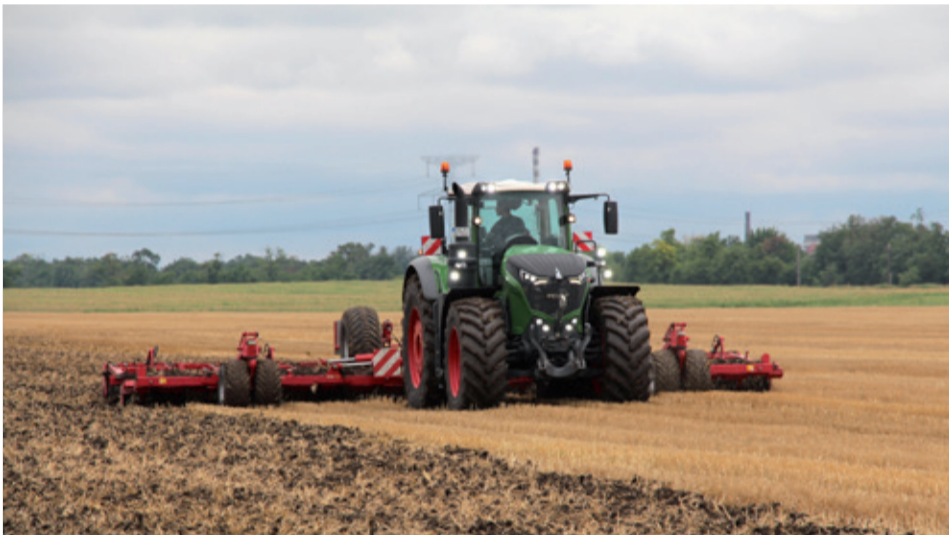
To, že sú traktory Fendt 1000 Vario predurčené pre veľké závesné náradia, predviedol najvýkonnejší Fendt 1050 agregovaný s tanierovým podmietáčom Joker 10 RT priamo na poli.
