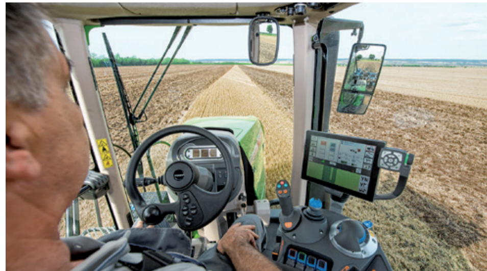
Jedná sa o prevzatý koncept pásových traktorov od koncernovej značky, avšak ovládanie vo vnútri kabíny je zhodné s ovládaním v ostatných veľkých kolesových traktoroch Fendt.
