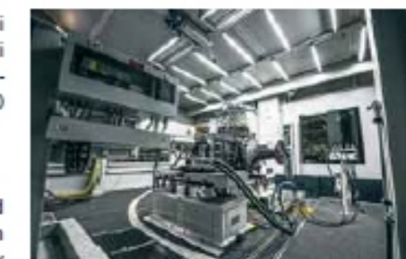
Testuje sa každý komponent prevodovky a funkčnosť celého systému.
