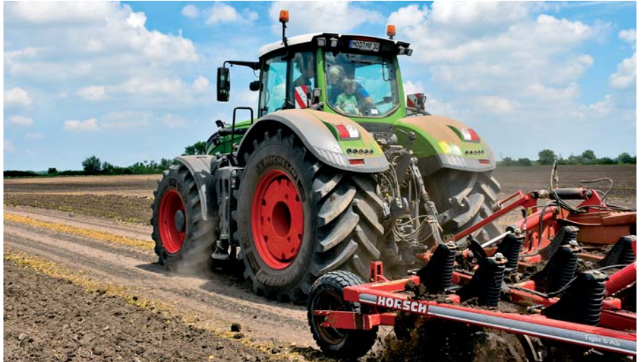
Horsch Tiger AS so záberom 6 m, ťahaný novinkou Fendt, pracoval do hĺbky asi 18 – 20 cm.
