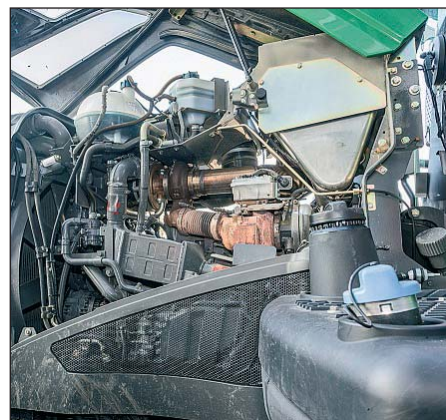
Deutz – šesťvalec má objem 7,8 l a dve turbodúchadlá. Splňa normu Stupeň IV.
