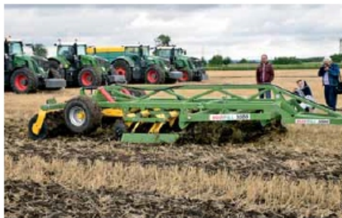
Svoje schopnosti predviedol aj kyprič Framest DuoTill so záberom 3 m. Prácu radličkovej a tanierovej sekcie uzatvára gumený valec.
