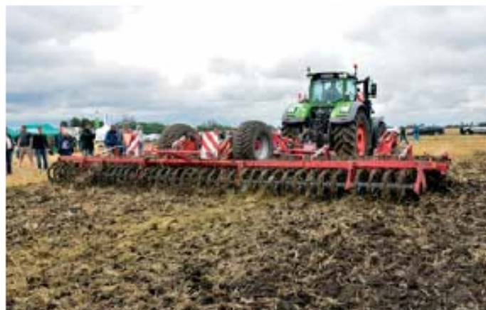
V Poľnohospodári obrábajú svoje poľa aj strojmi značky Horsch. Okrem bežnej „klasiky“ u nich nájdete aj univerzálny sejací stroj Pronto 9 DC či tanierový podmietač Joker 10 RT so záberom 10 m, agregovaný s traktorom Fendt 1050.
