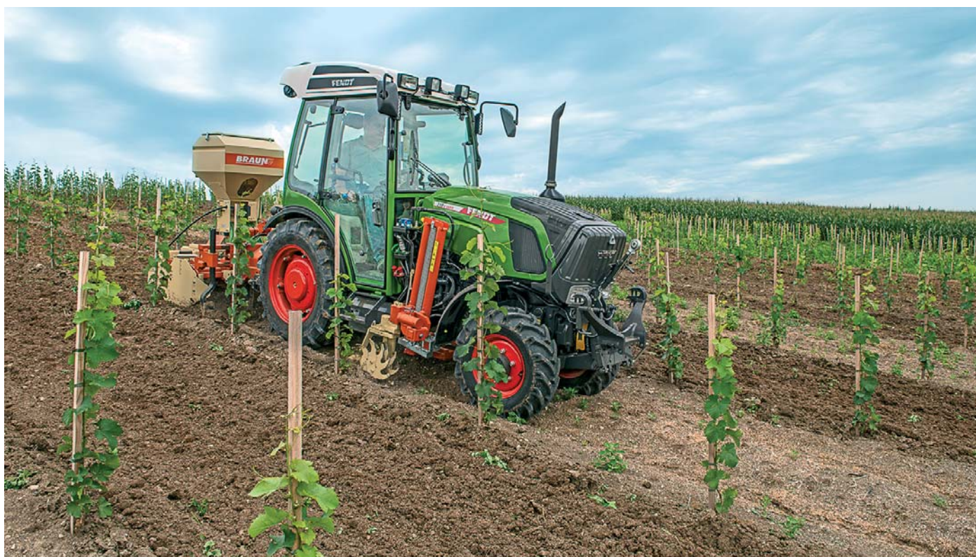
Fendt 200 sa navádza pomocou ultrazvuku v riadkoch, alebo GPS navigáciou.
