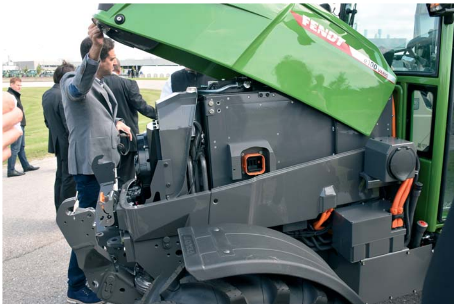
Pod kapotou e 100 Vario sa nachádza 650 V batériu typu lítium-ión s kapacitou približne 100 kWh.
