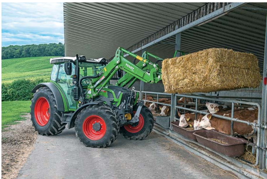
VarioActive regulujete počet otočení volantu pri vytočení prednej nápravy z jednej krajnej polohy do druhej. Do rýchlosti 8 km za hodinu postačuje jedna otočka volantu.
