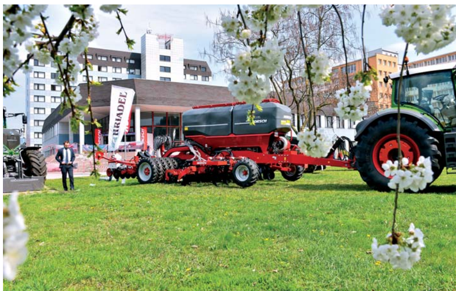
Sejací stroj Focus TD s možnosťou deponovania hnojiva do rôznej hĺbky k osivu v závislosti od pôdnych podmienok.
