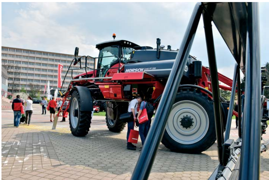
Ťahané a samohybné postrekovače HORSCH sa vyznačujú výbornou kopírovacou schopnosťou a stabilitou ramien. Preto môžu striekať s 25 cm vzdialenosťou nad porastom, čím sa znižuje úlet kvapiek až o štvrtinu.
