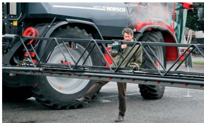
Nové postrekovače HORSCH-Leeb vďaka stabilite ramien bežne postrekujú v rýchlostiach 20 – 30 km za hodinu, na úvratiach sa presúvajú rýchlosťou 10 – 15 km za hodinu. Reakcie ramien na prekážku predviedol Theodor Leeb.
